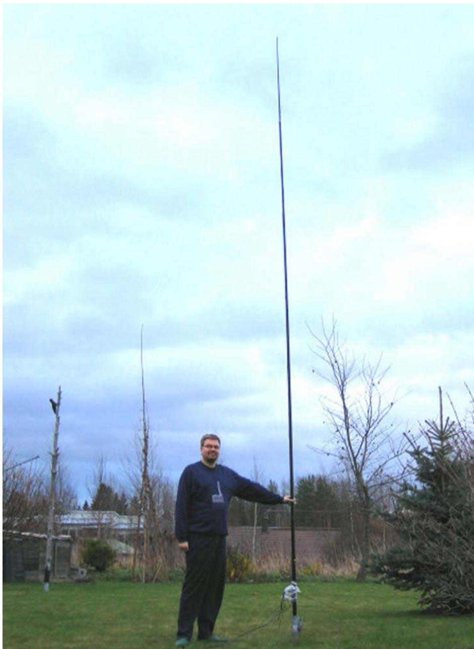
Kuva 2. Ongenvapavertikaali 14 MHz:n bandille. Kirjoittaja mittatikkuna.
